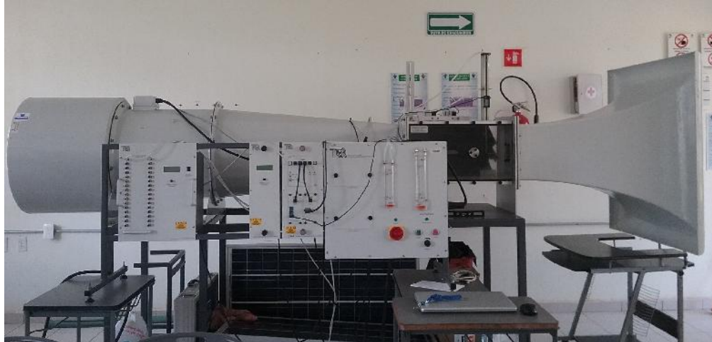
Figura 5.13. Túnel de viento modelo AF100.
