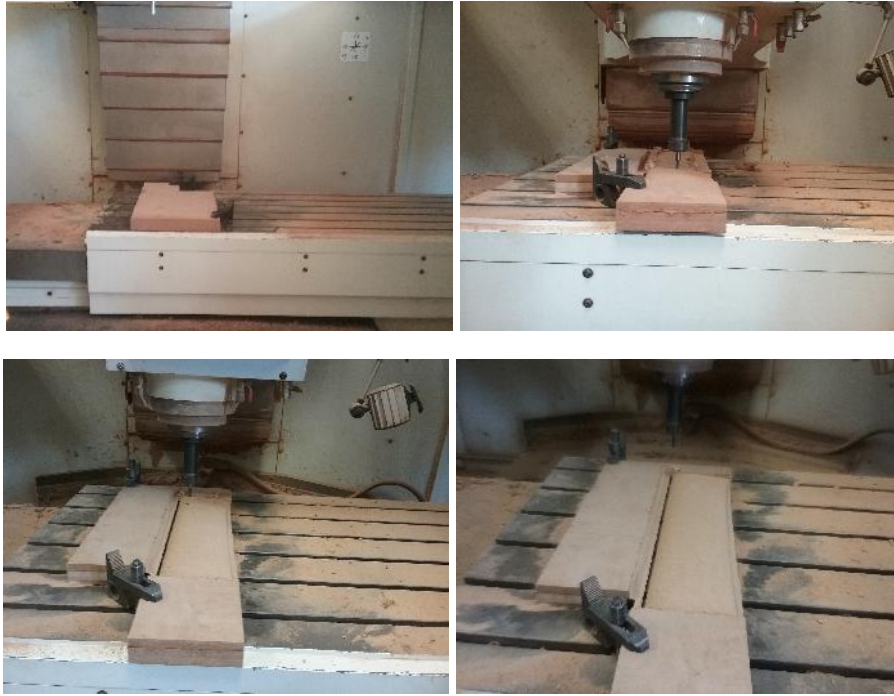
Figura 5.11. Manufactura de la probeta del perfil S822.
