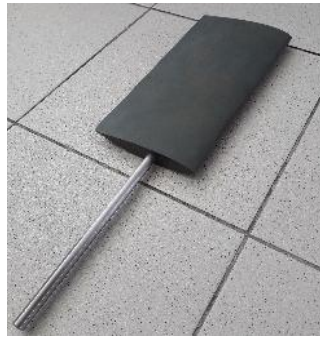
Figura 5.12. Probeta del perfil S822 con envergadura de 300 mm.
